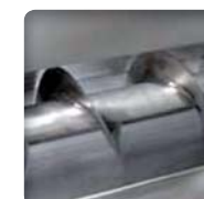
Type de spires pour permettre le transfert de différents matériaux
