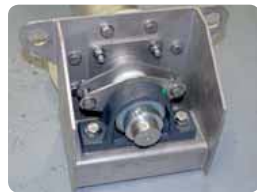
2. Paliers à semelle déportés pour des produits poudreux et abrasifs. Une insufflation d'air peut être rajoutée par un système de bague à lanterne.
