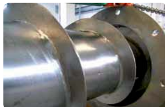
2. Les vis ayant un diamètre d'arbre surdimensionné ne nécessitent pas de paliers intermédiaires et possèdent une distance de transfert importante. Pour les produits abrasifs, l'alternative au palier intermédiaire est le surdimensionnement de l'arbre.
