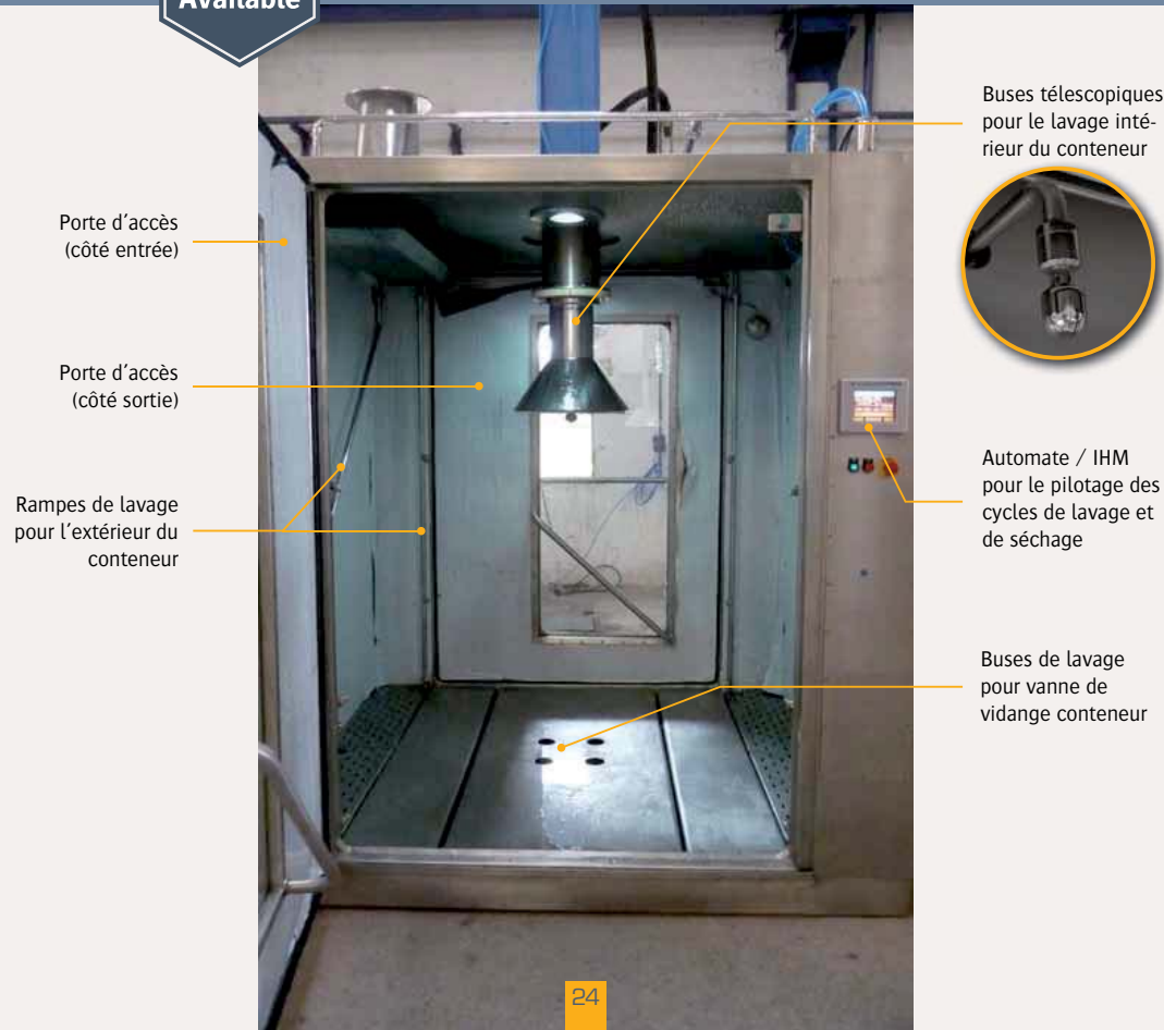
▶ Porte vitrée avec joints gonflants pour surveiller le processus de lavage et garantir une étanchéité optimale
