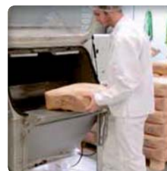
▶ L'opérateur dépose le sac et actionne la commande de coupe.
