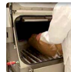
▶ Secouage du sac sans effort et sans manutention lourde du sac. L'opérateur n'a pas besoin de retourner le sac.
