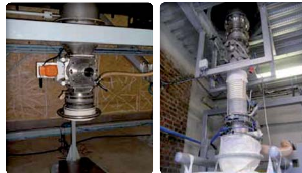
Application au dessus de conditionneuse pour permettre le dosage du produit
