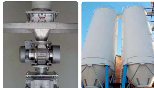
Application sous alimentation transport pneumatique pour assurer le chargement du produit dans la tuyauterie de transfert
