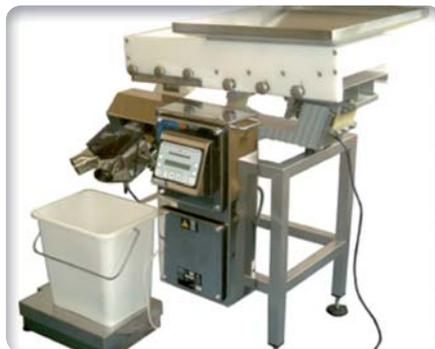
► Couloir vibrant avec détection métallique intégrée pour gélules
