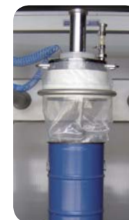
Joint gonflant pour un remplissage totalement confiné
