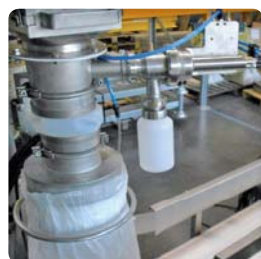
▶ Échantillonneur manuel ou automatique pour contrôler la qualité du produit
