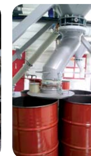
Faux couvercle avec bride tournante pour remplissage sur palette
