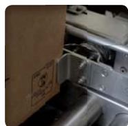
▶ Point de butée pour stopper la progression des cartons et permettre leur retrait par l'opérateur
