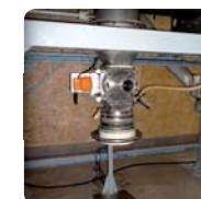
➤ Ecluse rotative pour dosage du produit
