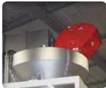
2 L'évent d'explosion permet l'évacuation de la pression d'explosion
