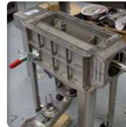
➤ Granulateur alimentant le transfert pneumatique par aspiration
