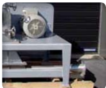
5 Le venturi assure le transfert du produit micronisé
