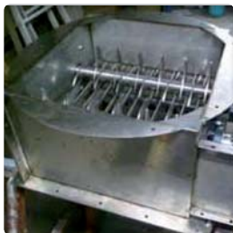
➤ Émotteur à couteaux intégrés à une station de vidange big bag pour pastilles de cire
