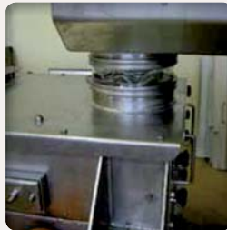
Manchette de connexion entre vis et tamiseur
