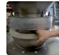
Joint tulipe pour assurer l'étanchéité de la connexion
