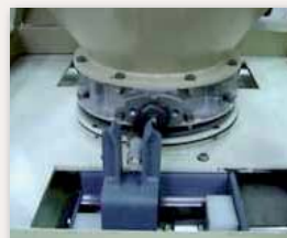
L'ouverture de la vanne peut être réalisée de façon automatique
