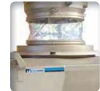
➤ Faux couvercle avec joint gonflant pour un confinement total
